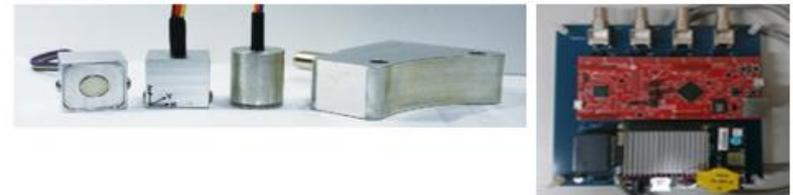
線上切削顫振檢測與抑制APP模組開發
