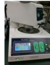
1台高轉速研磨拋光機(1000rpm)、2台晶片研磨機(具備振動輔助裝置)、
